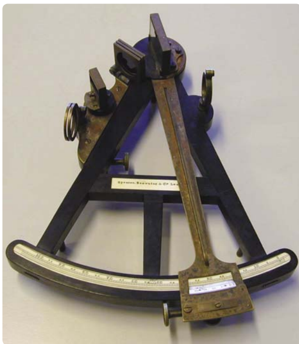
Oktant fremstillet af Spencer, Browning & Co ca. 1860, Steno Museet. (Foto: Thorbjørn Kristensen)
