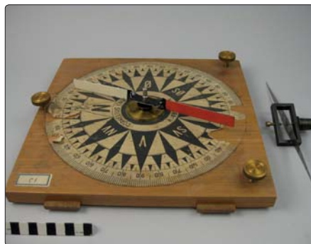
Demonstrationskompas med udskiftelig nål. Foto: Mads Steiner Nielsen.
