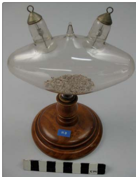
Katodestrålerør med fluorescerende mineraler. Foto: Mads Steiner Nielsen.
