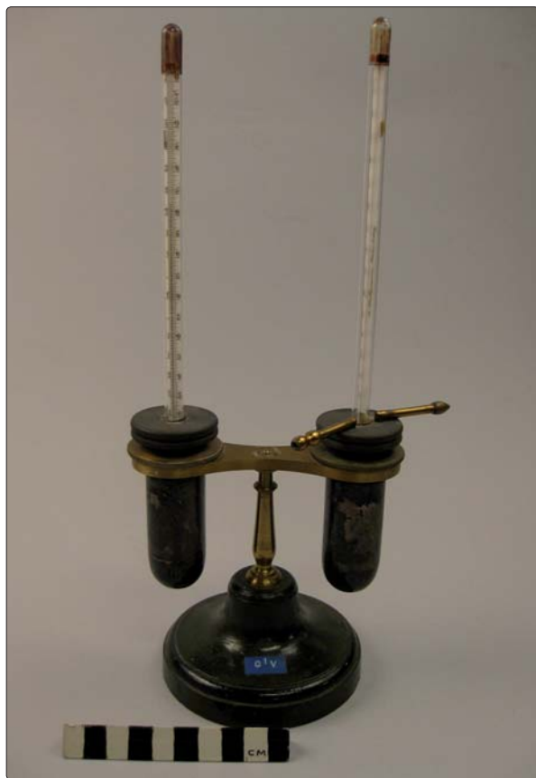
Hygrometeret – eller Regnaults dugpunktinstrument – er fremstillet af den kendte instrumentmager C. Weitzmann. Foto: Mads Steiner Nielsen.
