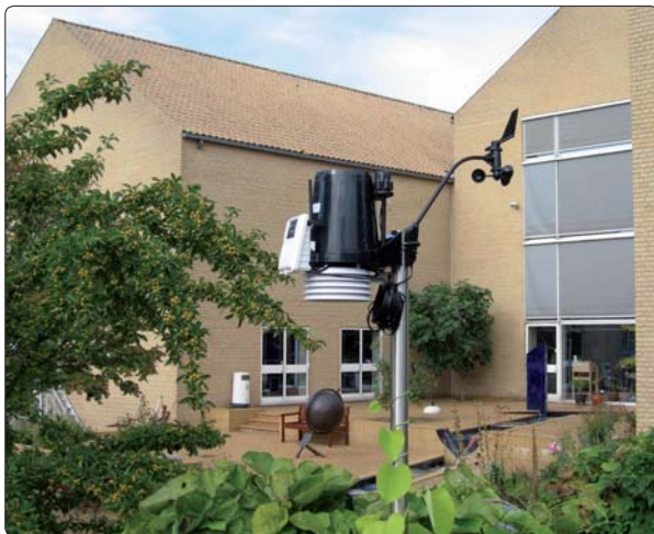
Steno Museets nye, automatiske vejrstation er monteret på en ca. 3 m høj mast i den yderste del af den medicinhistoriske urtehøve. Foto: Hans Buhl.
