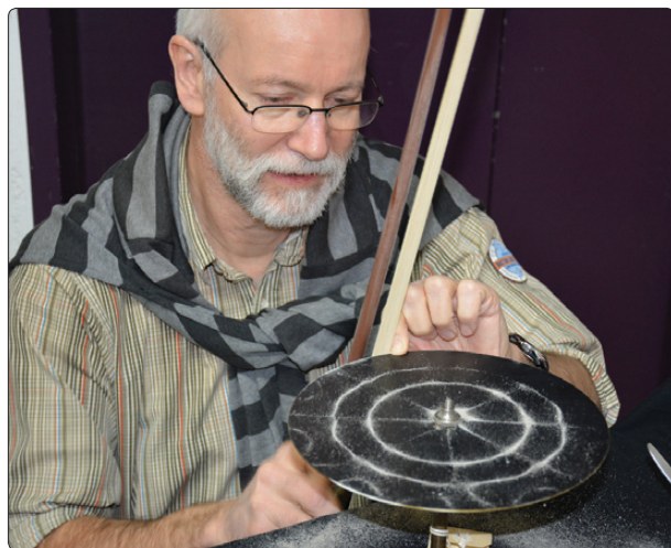
Klangfiguren opstod, da museumsinspektør Hans Buhl satte pladen i svingninger med violinbuen. Nogle steder laver pladen udsving, andre steder intet. Sandet lægger sig til hvile på de sidstnævnte steder. Foto: Mary Marie Kromann.
