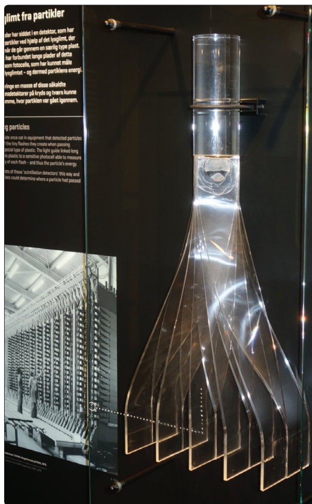
I udstillingen ses en kunstfærdigt udformet lysleder af plexiglas, som har forbundet flere lag af scintillationsplader med en rund fotomultiplikator. På fotografiet til venstre ses, hvordan der har været mange lag af sådanne detektorer på kryds og tværs. Derved var det muligt omtrent at bestemme en partikels bane gennem hele detektoren. Foto: Hans Buhl.
